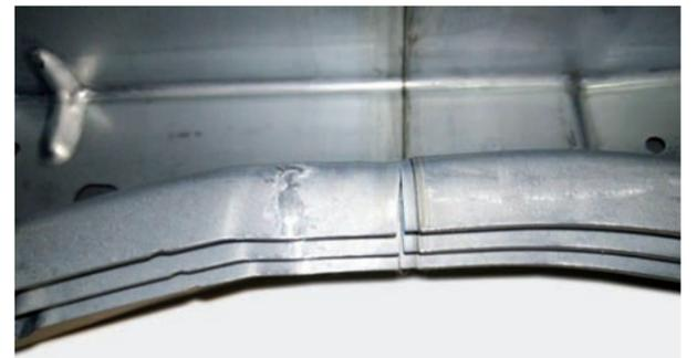
Im August 2021 traten bei der Produktion der Tailer Welded Blanks sporadisch Kantenrisse mit unterschiedlicher Länge auf. Ursache unbekannt.
