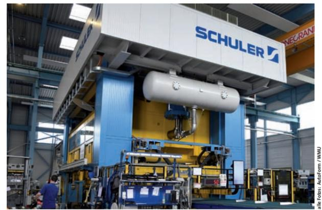
Auf einer Schuler-Presse, die bei 1600 Tonnen Presskraft und 7,3 Meter Tischlänge mit der Twinservo-Technologie arbeitet, werden die Längsträger für einen europäischen Hochvolumenhersteller gefertigt
