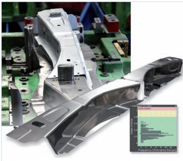
Mithilfe der Simulationssoftware von Auto Form kommt Weser Metall dem Grund für sporadisch auftretende Risse in der Nähe der Schweißnaht auf die Spur
