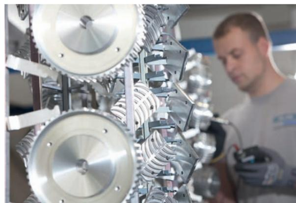
Bestens vorbereitet für das anodische Oxidieren: Aluminium-Werkstücke kurz vor dem Eintauchen ins Prozessbad
