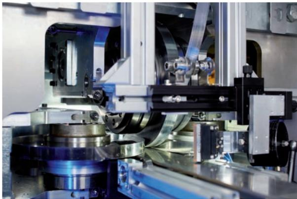
Sandwich-Metallstrukturen lassen sich besonders effizient im Rolle-zu-Rolle-Verfahren produzieren. Dadurch eröffnen sich neue Leichtbauperspektiven.
