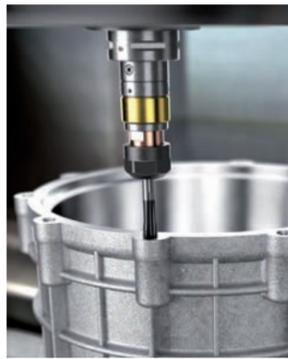
Der geradegenutete Gewindebohrer CoroTap 100 verfügt über eine verfeinerte Kantenverrundung, die zur Gratreduzierung beiträgt und die Oberflächengüte verbessert
