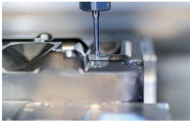
Flache Bereiche für das Gesenk werden mit dem Eckradiusfräser Mapal OptiMill-3D-CR geschlichtet, um schnell gute Oberflächen zu erzeugen
