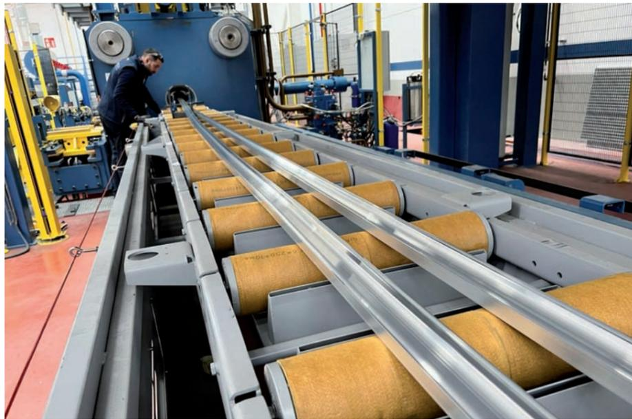
Die neue 40 MN Frontlader-Strangpresse von Extrusax wurde zu Beginn 2023 in Betrieb genommen. Technisch sind Profilquerschnitte bis 425 mm und bis zu einem Gewicht von 35 kg/m pressbar.
